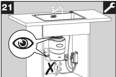
Ponga el aparato en funcionamiento como se describe en el siguiente capítulo "Primera puesta en funcionamiento". Para finalizar, vuelva a comprobar que todas las conexiones de manguera y de tubo, y el desagüe del fregadero son estancos.
