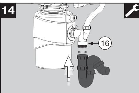
Fermez votre siphon en S/tubulaire (non inclus dans la livraison) sur la sortie inférieure du tube coudé d'évacuation (16) et sur votre raccordement des eaux usées domestiques.
