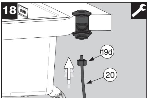
Suelte la tuerca de manguera (19d) del interruptor neumático / interruptor de aire. Desplace la tuerca sobre la manguera neumática (20).
