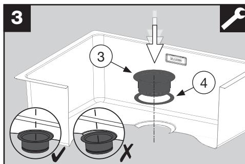
Positionnez la bride d'évier (3) avec le joint en caoutchouc en haut (4) dans l'ouverture d'évacuation de l'évier. Veillez à ce qu'il soit positionné au centre.
