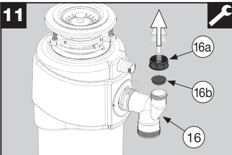
Retire el tapón ciego (16b) del tubo en L de desagüe (16), soltando la tuerca de rebosadero (16a).
