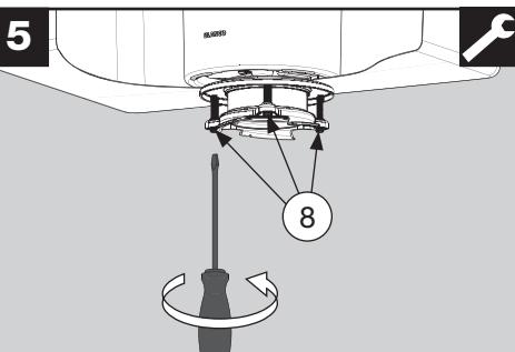
Spænd de tre skruer på holderingen (8) jævnt.
