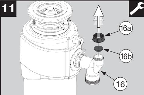
Удалите заглушку (16b) из сливного отвода (16), для чего отверните гайку перелива (16a).
