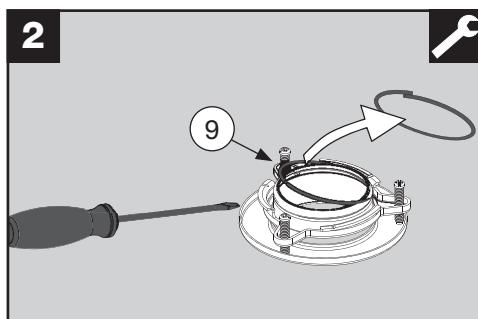
Faites levier pour extraire le circlip (9) avec un tournevis cruciforme long et déposez-le.
