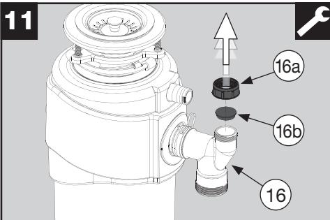
Retirez le tampon borgne (16b) du tube coudé d'évacuation (16) en desserrant l'écrou du trop-plein (16a).
