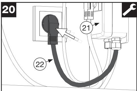
Stecken Sie nun den Netzstecker (22) der Schaltbox (21) in die Steckdose.
