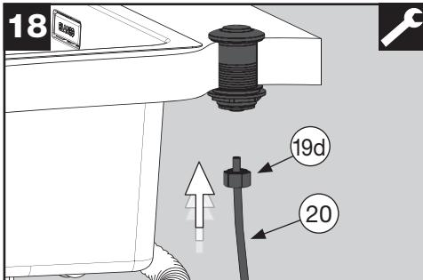
Desserrez l'écrou de tuyau (19d) du bouton de l'interrupteur pneumatique. Poussez l'écrou sur le tuyau d'air comprimé (20).
