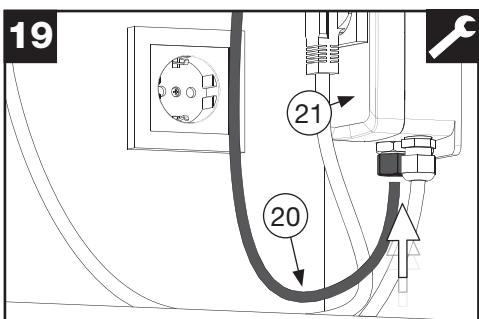
Verbinden Sie das andere Ende des Druckluftschlauchs (20) mit der Schaltbox (21) und sichern Sie den Schlauch wie in Schritt 18 beschrieben mit der Schlauchmutter.
