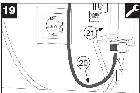
Conecte el otro extremo de la manguera neumática (20) con la caja de distribución (21) y asegure la manguera con la tuerca de manguera tal como se describe en el paso 18.
