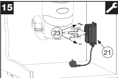
Monter kontaktboksen (21) med tre skruer (23) på siden af et underskab i nærheden af en stikkontakt som vist.
