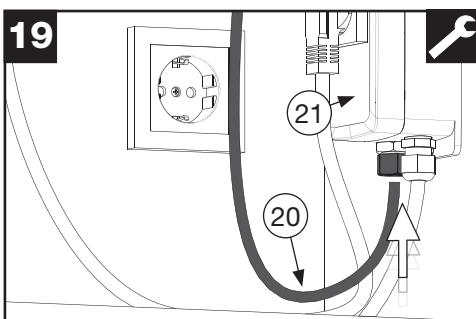
Подсоедините другой конец пневматической трубы (20) к распределительной коробке (21) и закрепите трубку гайкой, как показано на рис. 18.
