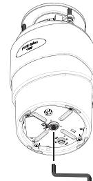
3. Inserire la chiave a brugola in dotazione nel foro centrale sul lato inferiore dell'apparecchio. Ruotare la chiave a brugola avanti e indietro finché non si riesce a farle compiere un giro completo. Poi togliere la chiave a brugola.
