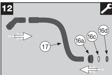
Bestimmen Sie die benötigte Länge des Überlaufschlauchs (17) und kürzen Sie diesen bei Bedarf.
