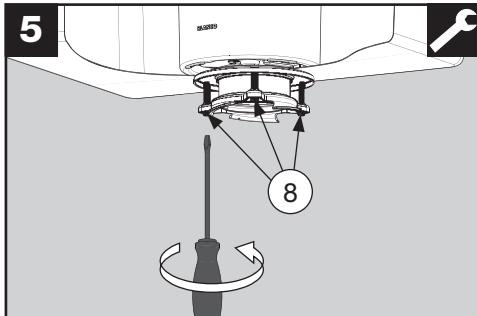
Равномерно затяните три винта крепёжного кольца (8).
