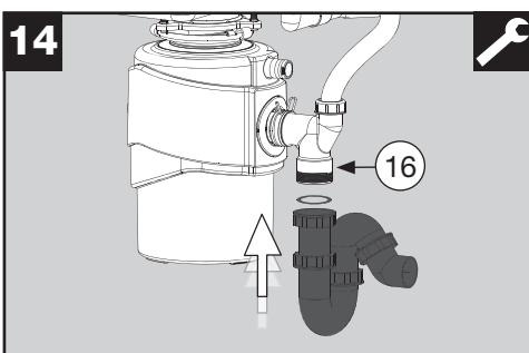
Slut din lugtfælde/vandlås (medfølger ikke) til den nederste udgang på afløbsrørbojningen (16) og til husets afløbstilslutning.
