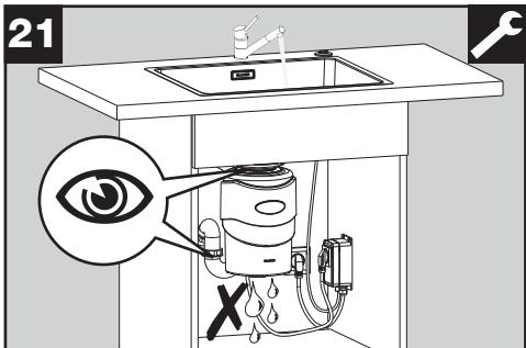
Nehmen Sie das Gerät in Betrieb wie im folgenden Kapitel „Erstbetriebnahme“ beschrieben. Überprüfen Sie am Ende nochmals alle Schlauch- und Rohrverbindungen und den Ablauf der Spüle auf undichte Stellen.
