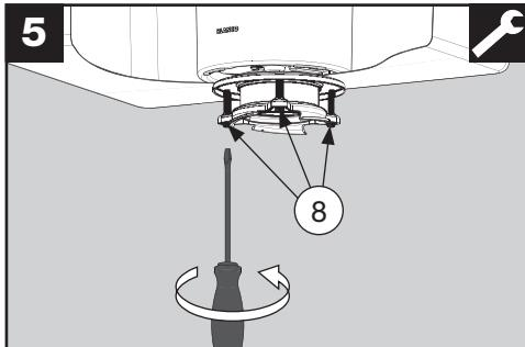
Apriete uniformemente los tres tornillos (8) de la arandela de sujeción.
