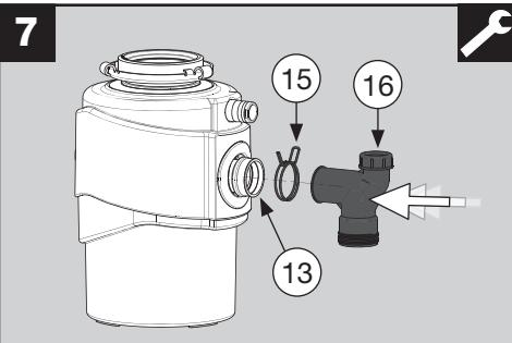
Connectez le tube de raccordement (16) avec la sortie anti-vibration de l'appareil (13) et consolidez l'ensemble avec le collier de serrage (15).
