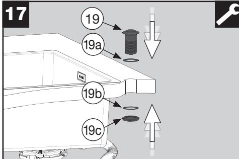
Fjern monteringsmøtrikken (19c) og trykluftafbryderens / Air switchens glidering (19b).
