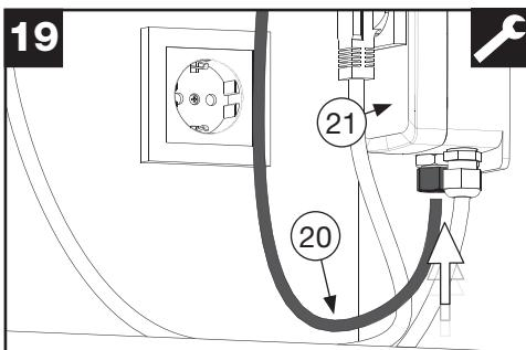
Raccordez l'autre extrémité du tuyau d'air comprimé (20) avec le boîtier de commutation (21) et sécurisez le tuyau avec l'écrou de tuyau comme décrit à l'étape 18.
