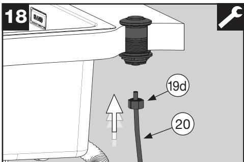
Lösen Sie die Schlauchmutter (19d) des Druckluftschalters / Air switch. Schieben Sie die Mutter auf den Druckluftschlauch (20).
