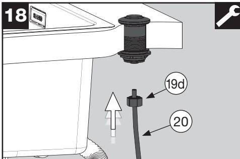
Отверните гайку трубы (19d) пневматического выключателя / Air switch. Наденьте гайку на пневматическую трубку (20).
