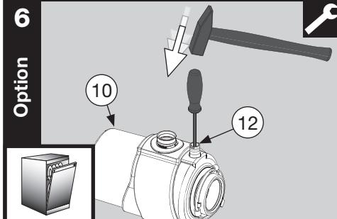
Optional (nur falls der Abfluss der Spülmaschine am Gerät angeschlossen werden soll):
