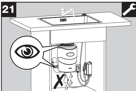
Включите измельчитель, как указано в главе „Первое включение“. Проверьте ещё раз отсутствие протечек во всех соединениях шлангов, труб и в сливе мойки.
