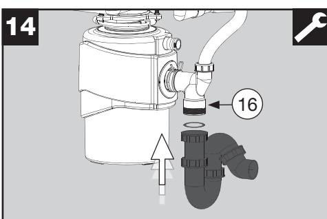
Schließen Sie Ihren Geruchverschluss/Siphon (nicht im Lieferumfang enthalten) an den unteren Abgang des Bogenabflussrohrs (16) und an Ihren Haus-Abwasser-Anschluss an.
