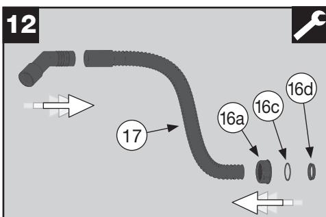
Determinare la lunghezza necessaria del tubo flessibile di troppopieno (17) e, se necessario, accorciarlo.
