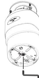
3. Вставьте прилагаемый шестигранный ключ в среднее отверстие на нижней стороне измельчителя. Поворачивайте шестигранный ключ в одну и в другую сторону, пока сможете сделать полный оборот. Затем выньте шестигранный ключ.
