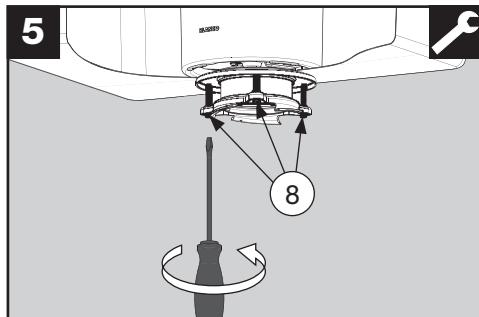
Ziehen Sie die drei Schrauben des Halterings (8) gleichmäßig an.
