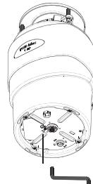
3. Inserte la llave hexagonal suministrada en el orificio central en la parte inferior del aparato. Gire la llave hexagonal de un lado a otro hasta que logre dar una vuelta completa. A continuación, retire la llave hexagonal.
