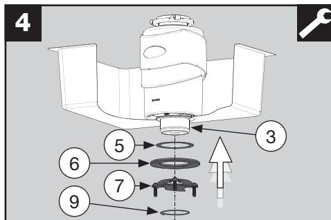
Enfoncez le joint d'étanchéité inférieur (5), la bague de protection (6) et l'anneau de support (7) depuis le bas sur la bride de l'évier et appuyez sur le circlip (9) dans la rayure de la bride d'évier (3).
