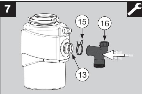
Collegare il tubo di scarico ad arco (16) all'uscita antivibrante dell'apertura di scarico (13) e fissarlo con la fascetta stringitubo (15).
