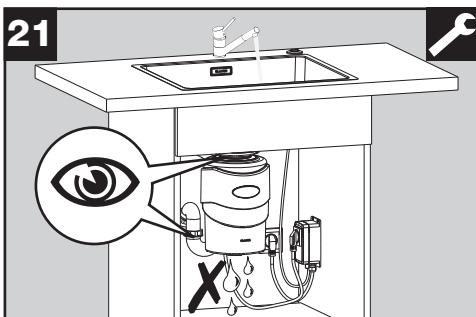
Mettez l'appareil en service comme décrit dans le chapitre « Première mise en service ». Pour terminer, vérifiez de nouveau tous les raccordements des tuyaux, flexibles, tubes et conduites ainsi que la sortie de l'évier à la recherche de sites non étanches.
