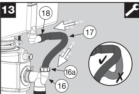
Deslice el adaptador de rebosadero (18) sobre el rebosadero de su fregadero (hasta el tope).
