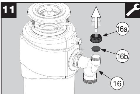
Entfernen Sie den Blindstopfen (16b) des Bogenabflussrohrs (16) indem Sie die Überlaufmutter (16a) lösen.
