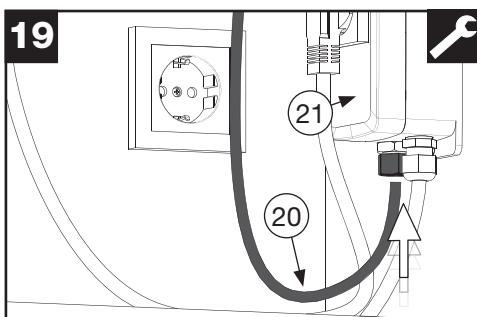
Forbind den anden ende af trykluftslangen (20) med kontaktboksen (21), og fastgør slangen med slangemøtrikken som beskrevet i trin 18.
