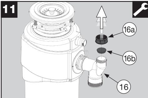
Fjern blindproppen (16b) på afløbsrørbojningen (16) ved at løsne omløbermøtrikken (16a).
