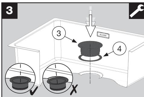
Вставьте сливной фланец (3) вместе с верхним резиновым уплотнением (4) в сливное отверстие раковины. Отцентрируйте фланец в отверстии.
