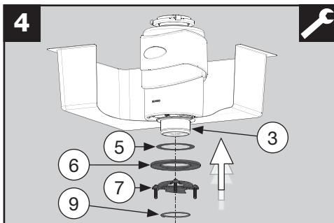
Наденьте нижнее уплотнение (5), упорное кольцо (6) и крепёжное кольцо (7) снизу на сливной фланец и вставьте пружинное стопорное кольцо (9) в паз этого фланца (3).
