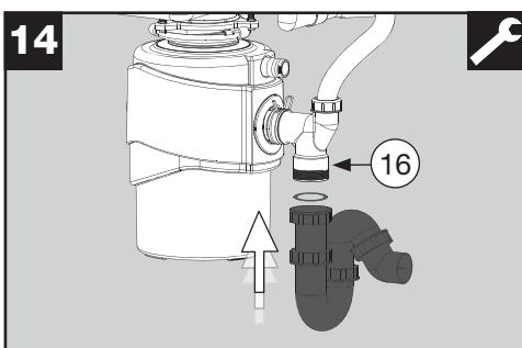
Collegare il sifone antiodori (non incluso nel volume di fornitura) all'uscita inferiore del tubo di scarico ad arco (16) e all'attacco di scarico domestico.
