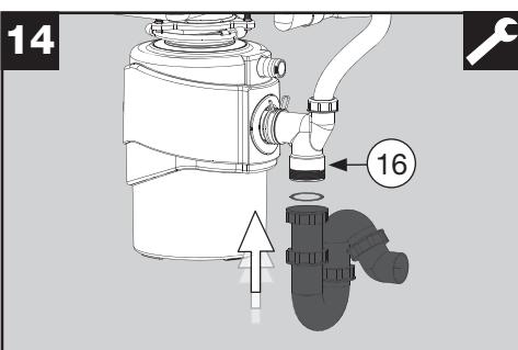
Подсоедините водяной затвор/сифон (не входит в комплект поставки) к нижнему выходу сливного отвода (16) и к канализационному сливу в помещении.
